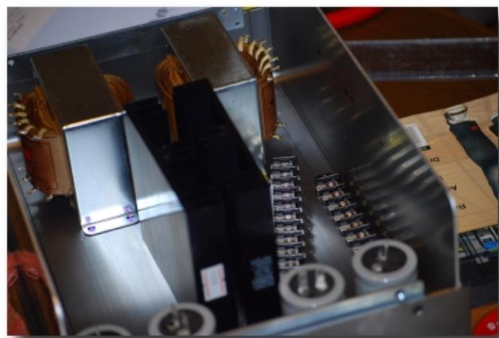
確定部分に穴を開けようと思って、午前にCDマーカーで印をつけようと思った。ブロック電解コンデンサは、トランジistorのすぐそばに配置したが、どうも発熱するものの近くに配置しないほうがいいことがわかったので、トランジistorと反対側に置くこと
