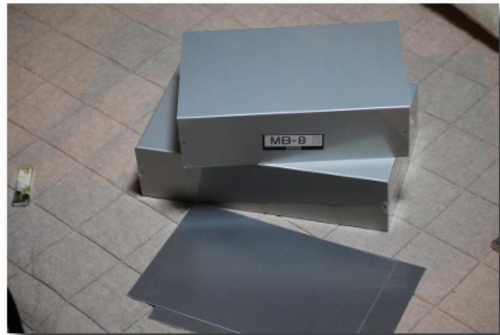
タカチのMB-8 (W190、H85、D300mm) とMB-9 (W210、H90、D350mm) 、さらに補強用にアルミ板NP40 (400、300mm) を210、190mmで切ってもらった。ラジオデパートの地下1Fの奥沢で、切り代も入れて5750円ぐらいだったかな。切った補強アルミ板はMB-8の底板にぴったりのとMB-9に50mm足りないものである。
