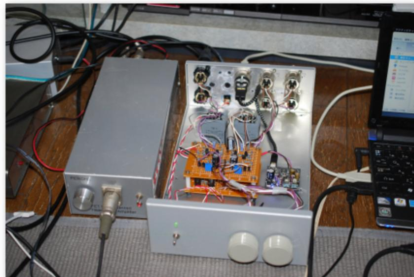
内部の写真。配線ミスがないように入力の導通などテスターで確認しながら配線した。
